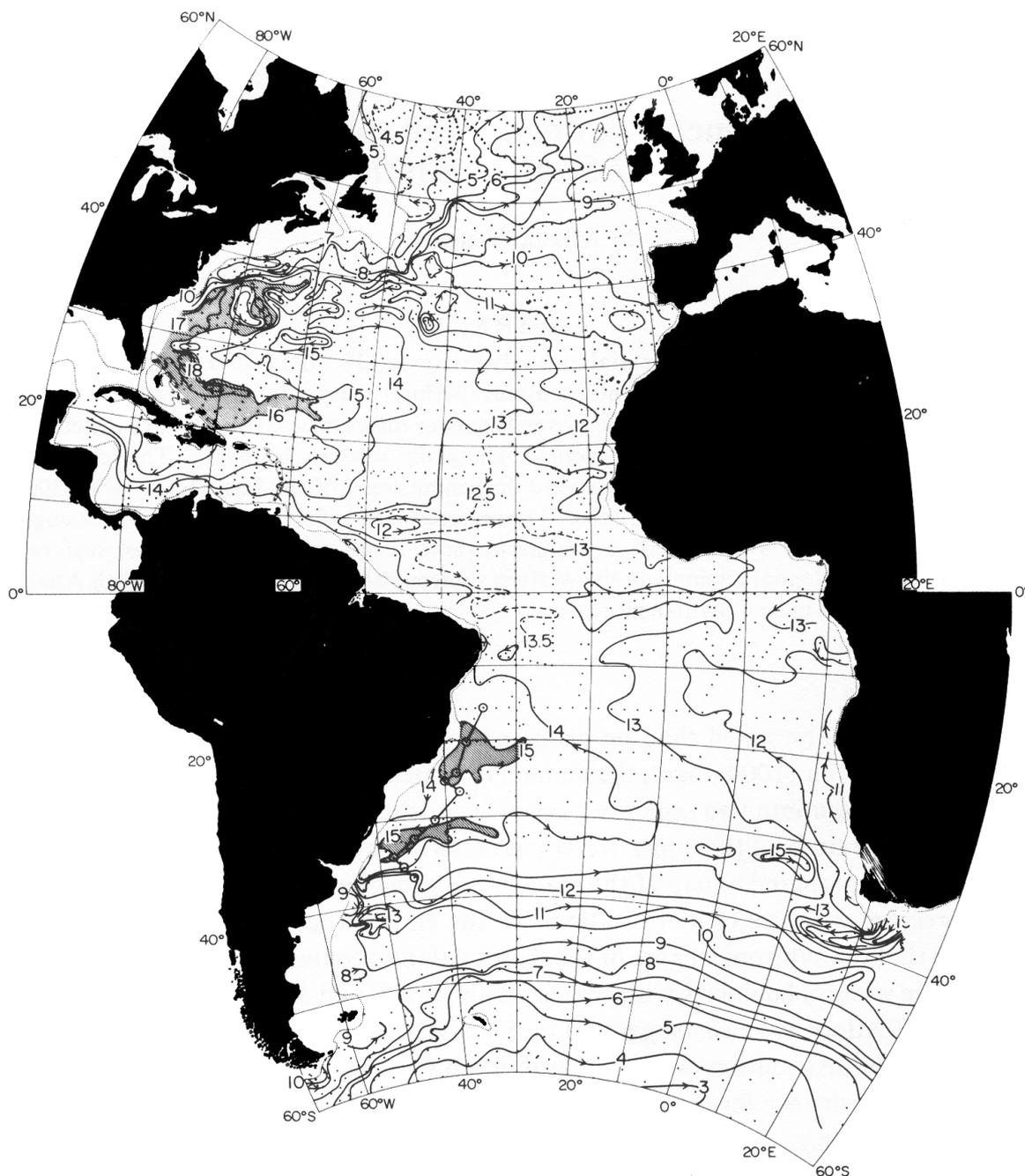
Figura 1.11: Anomalia do geopotencial em superfície, dada em  $\text{m}^2 \cdot \text{s}^{-2}$ , relativa a 1000 dbar. A linha fina circundante aos continentes representa a isóbata de 400 m. As áreas rachuradas indicam a assinatura das células anticiclônicas associadas às recirculações das CCOs subdividindo os giros subtropicais próximo ao contorno oeste. De acordo com Tsuchiya [1985].
